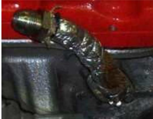
Dieser Adapter sollte so gefertigt werden, das er nicht mit dem Auspuffkrümmer in Konflikt kommt. (Meine Ausführung ist aus einem gebogenen Stahlrohr auf mit aufgeschweißten Dash10 Anschluss, soll aber noch einem gefrästen Aluadapter weichen.)
