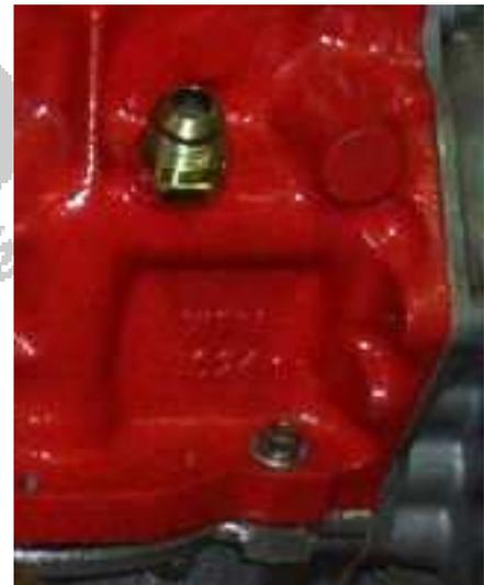
Diese beiden Adapter, werden dann mit Dash10 Schläuchen, mit einem ext. Ölfilteradapter verbunden (auf Eingang und Ausgang der Ölschläuche am Ölfilteradapter achten). Der Ölfilteradapter sollte höher als die Ölpumpe angebracht werden. Den Ölfilter nach jedem Wechsel vorher mit Öl befüllen.
